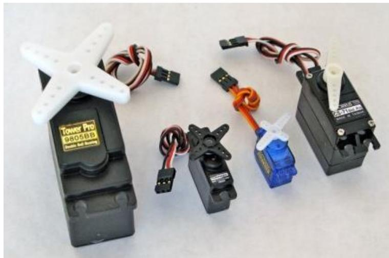
I servomotori nonostante siano pilotati da segnali PWM (Pulse Width Modulation) consistono, meccanicamente, di un motore DC con una serie di riduttori. Quest'ultimi permettono di ridurre la rotazione finale del motore così da ottenere una coppia maggiore.
